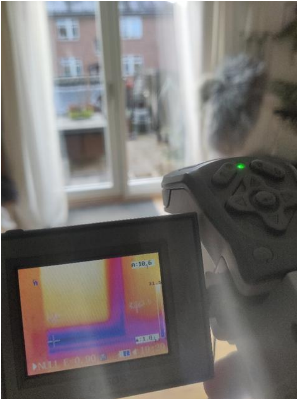
Et termografikamera viser temperaturen med forskellige farver
