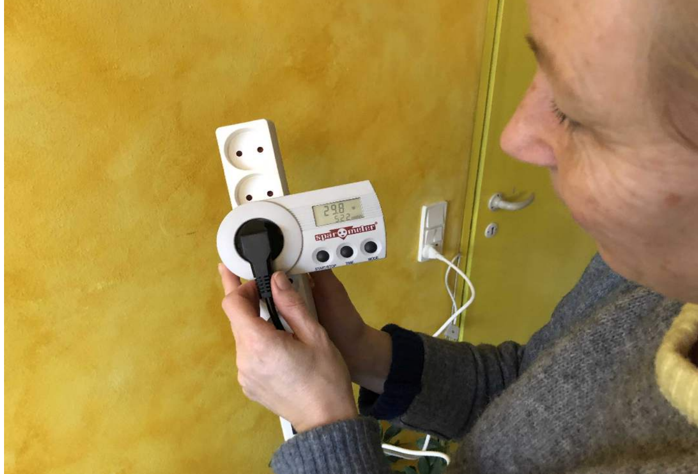
SparOmeteret måler strømforbrug og pris
